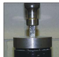
2. Utilisation de l'essai de coupe dans des conditions particulières de tests comme essai simple et rapide pour estimer les caractéristiques mécaniques des matériaux rocheux.
